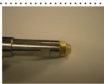
Das Anziehen der Öldüse erfolgt grundsätzlich mit einem Ring-schlüssel
